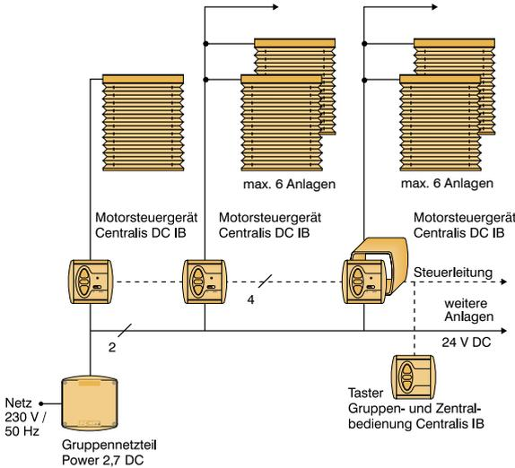
**Bitte maximale Anzahl der Antriebe je Netzteil beachten. Gegebenenfalls Gruppennetzteil Power 4,5 DC einsetzen**
